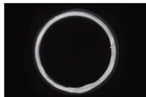
由于只有胶产生荧光散射, 因此可实现涂抹状态的成像。
